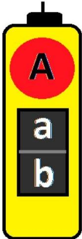
Для полной остановки тали нажмите красную кнопку **A** (СТОП), она легко зафиксируется в положении стоп.
